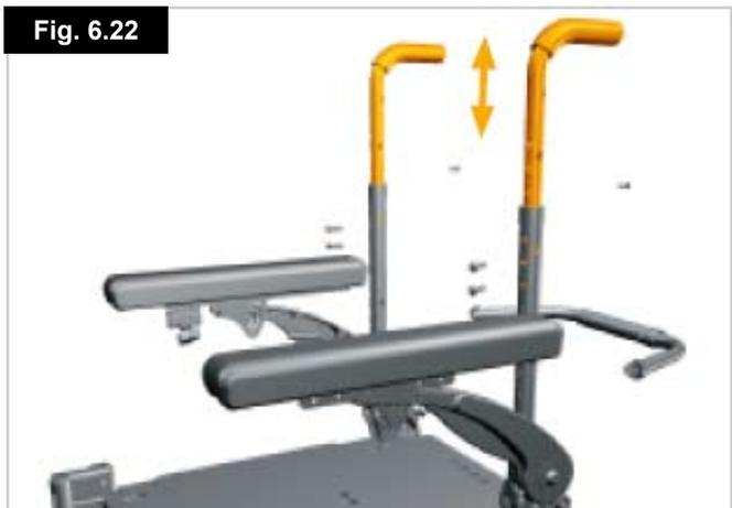
7. Volte a instalar os parafusos de ajustamento da barra traseira. Aperte 10 Nm ou 88,5 lbf/pol do binário, (Fig. 6.23).
